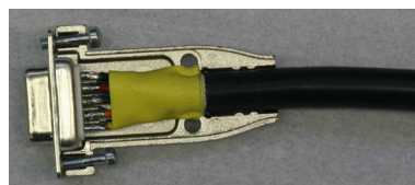
Fig. 8.11. Conector Sub D9 después del ensamblaje
