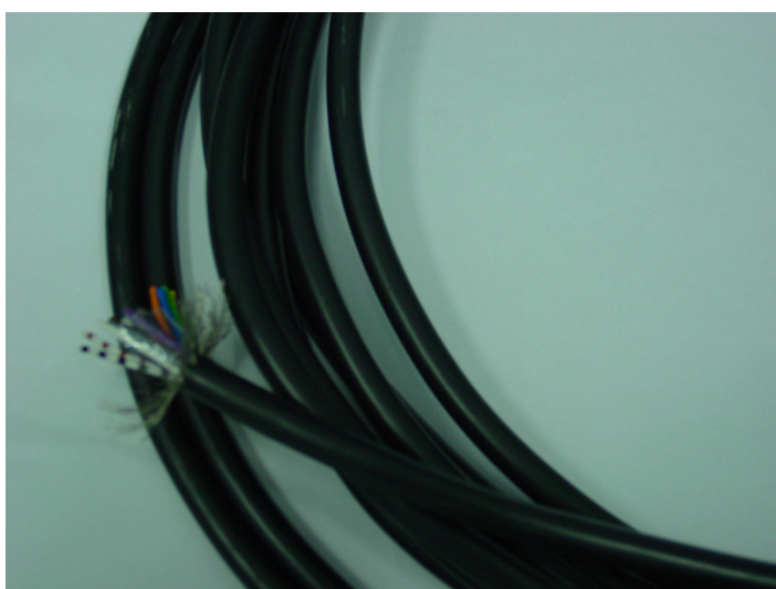
Fig. 7.22. Cable de comunicación de 12 núcleos
