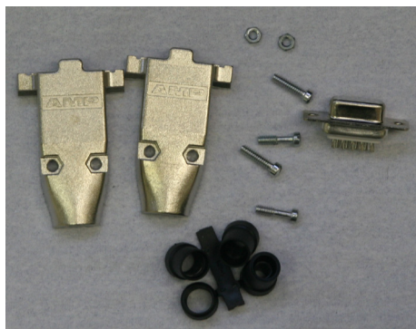
Fig. 8.10. Conector Sub D9 antes del ensamblaje
